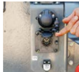
□ Une prise 12 V est disponible à l'arrière pour brancher les équipements externes. Le raccord ISOBUS permet de disposer d'une connexion aux outils.
