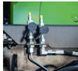
■ Pour tendre les trains de chenilles, les raccords de pression sont facilement accessibles.
