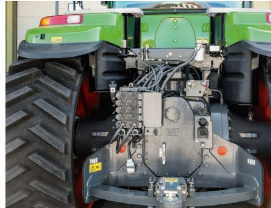
La barre d'attelage, à oscillation hydraulique de 28° de chaque côté, commande les outils à la perfection.
