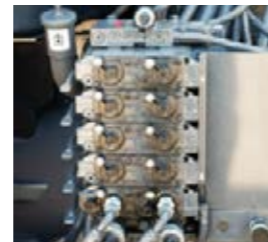
■ Six distributeurs hydrauliques, un retour hydraulique et le système PowerBeyond sont situés à l'arrière.
