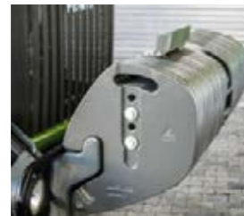
■ Un lest supplémentaire de 990 kg peut être monté sur le châssis avant.
