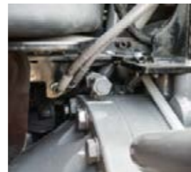
■ Le moteur est monté de manière à ce qu'il soit amorti.
