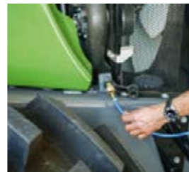
□ Un raccord d'air comprimé situé à l'avant permet de nettoyer le radiateur.
