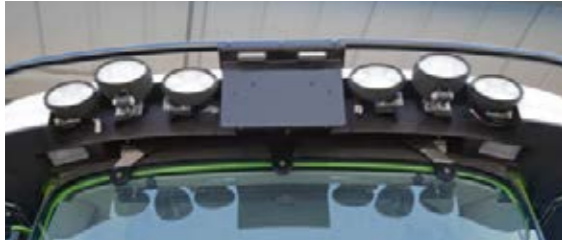
■ Les feux de travail au xénon NightBreaker éclairent parfaitement les alentours. Des phares à LED sont disponibles en option.
