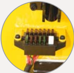
Scatola portafusibili compatta per facilitare l'ispezione
