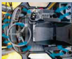
Climatisation et chauffage
