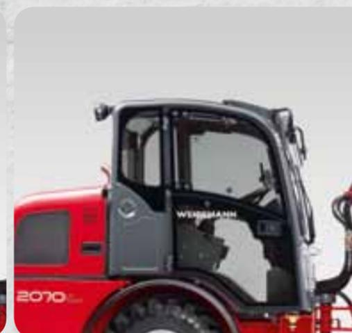
La cabina è compresa nell'altezza di ingombro bassa del tetto di protezione del guidatore.
