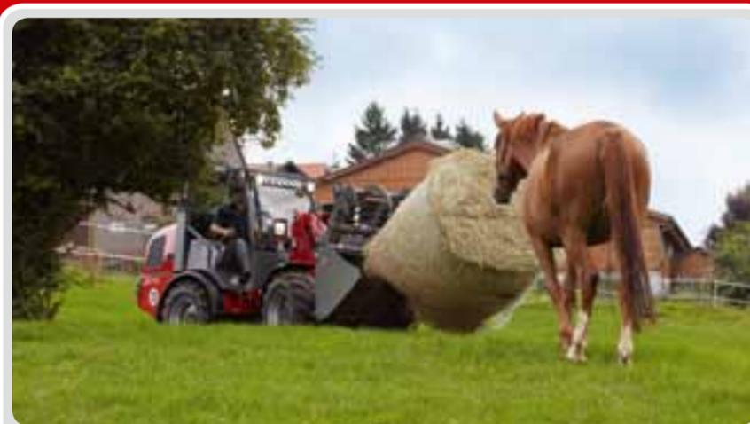
**TUTTA LA FORZA PASSA ATTRAVERSO IL PEDALE DI FRENATURA E AVANZAMENTO LENTO PER ARRIVARE ALL'IDRAULICA DEL BRACCIO DI CARICO OSCILLANTE.**
