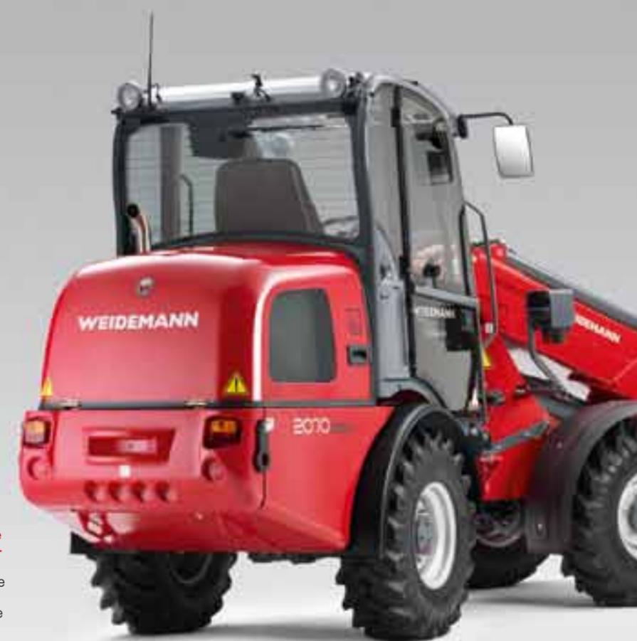
Zavorra posteriore massiccia e sporgente a protezione della macchina e compensazione durante operazioni di sollevamento ad altezze elevate. Il contrappeso sporgente fa sì che l'intera parte posteriore del veicolo, comprese le luci posteriori ribassate, sempre ottimamente protetta.
