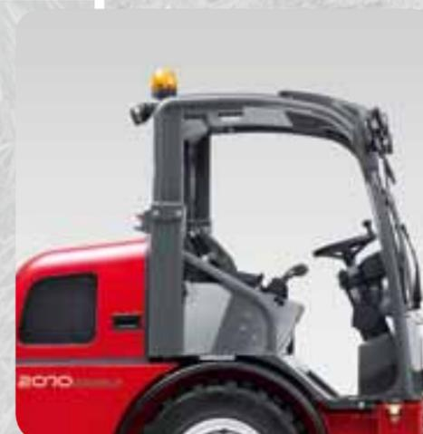
Considerando anche lo stabile tetto di protezione del guidatore, la pala caricatrice 2070 LP T arriva solo a 2248 mm di altezza. Misure ideali per lavori al coperto e all'esterno.
