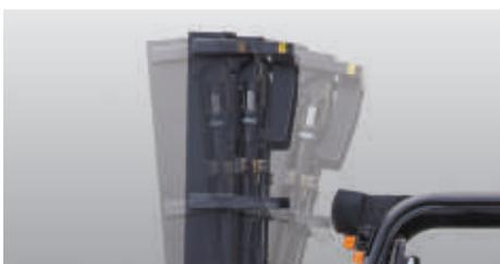
**Sistema di livellamento automatico delle forche (opzionale)**
