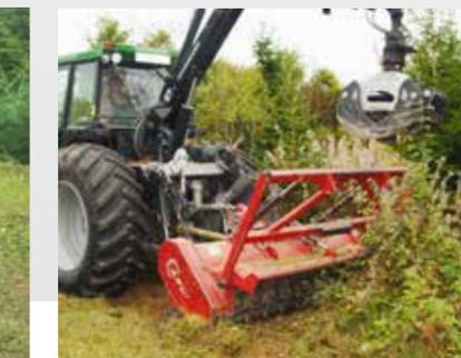
Bestandteil des Kotschenreuther Forstspezialschleppers ist ein Schnellwechselsystem, das die Maschine in wenigen Minuten zum universell einsetzbaren Allrounder gestaltet, wie z.B.: Mulchkopf, Holzhäcksler, Planierschild, Zapfwellenarbeiten, Bergstütze im Schnellverschluss (dadurch Dreipunktbau KAT III oder Rückanhängerbetrieb) und vieles mehr...
