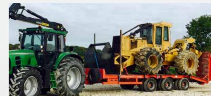
Dank des einfachen Ankoppelns des Hinterwagens verwandelt sich der 4X4-Forstspezialschlepper in kürzester Zeit in eine K-KOMBIMASCHINE 8X8.
