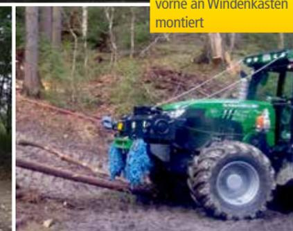
Schwenkrolle klappbar vorne an Windenkasten montiert
