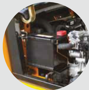
Schwenkbar installierte Batterie
