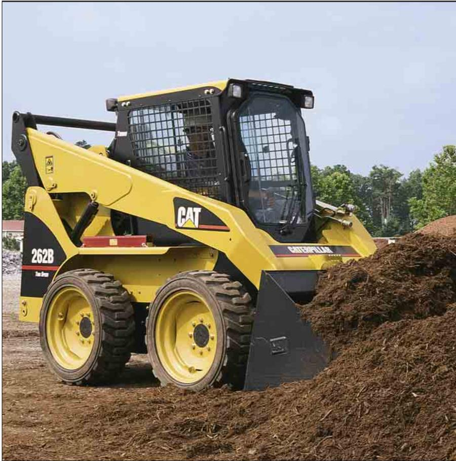
**Dieselmotor.** Der bewährte, langlebige Cat Vierzylinder-Viertaktmotor 3044C T mit Abgasturbolader stellt reichlich Leistung und Durchzugskraft für alle vorkommenden Kompaktladereinsätze zur Verfügung. Dank der schadstoffarmen Verbrennung werden die Abgasemissions-Grenzwerte gemäß EU-Richtlinie 97/68/EG, Stufe II, deutlich unterschritten.
