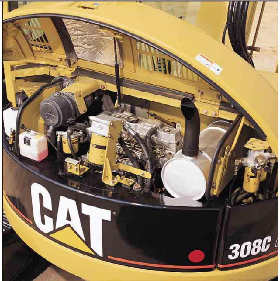
**Kühlsystem.** Groß dimensionierter Lüfter und über die gesamte Länge von Kühlwasser umspülte Zylinder bewirken eine hervorragende Wärmeabfuhr. In Verbindung mit dem ausgezeichneten thermischen Wirkungsgrad des Motors werden dadurch Überhitzungen bei starker Maschinenbelastung vermieden.
