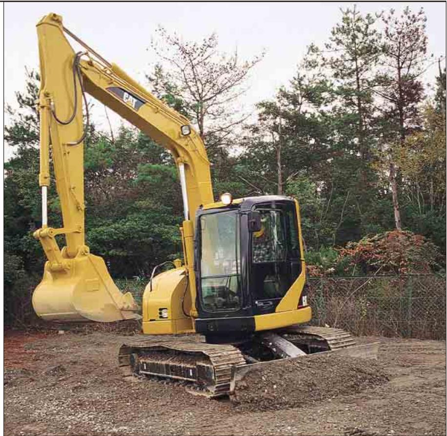
**Unterwagen.** Der Unterwagenrahmen wurde in X-Form mit hoher Verwindungssteifigkeit konstruiert. Stark ausgelegte Laufwerkskomponenten sichern eine lange Nutzungsdauer. Das Schweißen des Hauptrahmens sowie der Laufrollenrahmen erfolgt durch Roboter, die eine gleich bleibend hohe Qualität gewährleisten. Durchgehende Schweißnähte bewirken eine optimale Spannungsverteilung.
