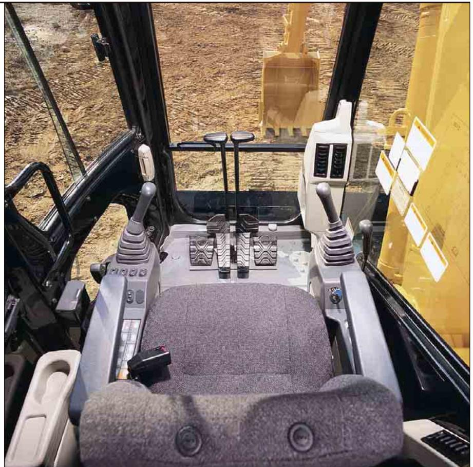
**Sicherheitshebel.** Mit dem Sicherheitshebel sperrt der Fahrer vor dem Verlassen der Kabine sämtliche Hydraulikfunktionen, damit keine unkontrollierten Bewegungen der Maschine ausgelöst werden.
