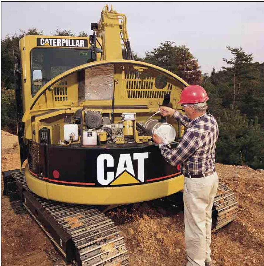
**Serviceintervalle.** Die Intervalle für Instandhaltungsarbeiten wurden verlängert, um die Betriebskosten zu reduzieren und die Maschinenverfügbarkeit zu erhöhen. Die Gelenke der Arbeitsausrüstung brauchen mit Ausnahme der Löffelbolzen nur noch alle 1000 Stunden abgeschmiert zu werden.
