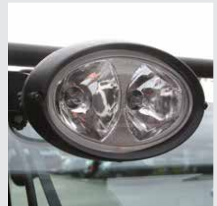
2 x Dual Power Arbeitscheinwerfer vorne, 1 x Single Power hinten
