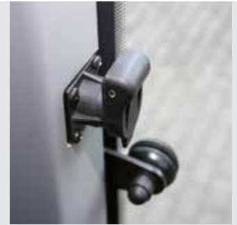
Steckdose mit Dauerstrom
