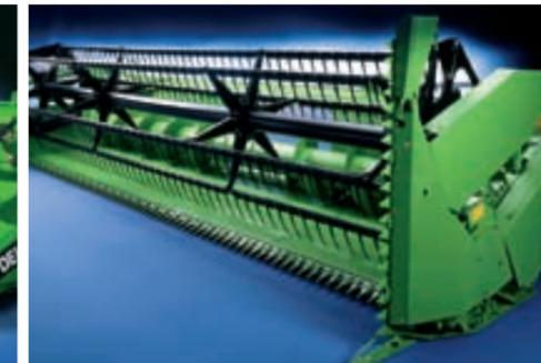
Zur Erweiterung des Einsatzbereichs kann das Getreideschneidwerk mit einem Rapsvorsatz leicht auf Rapserte umgestellt werden.
