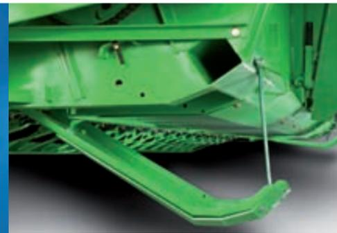
Die Niveauregelung sorgt auch bei unebenem Boden für eine gleichmäßige Schneidwerksführung und sofortige Anpassung an alle Geländeformen.
