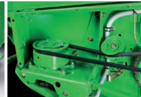
Dank Planetenantrieb und einer Schnittfrequenz von 1.220 Schnitten pro Minute ist unter allen Einsatzbedingungen stets ein schneller und präziser Schnitt gewährleistet.
