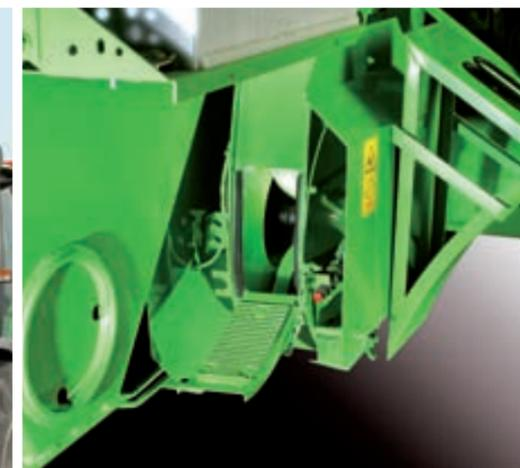
Der doppelte, unabhängige Rücklauf vermeidet Überlastungen des Dreschsystems zugunsten höherer Arbeitsqualität und Produktivität.
