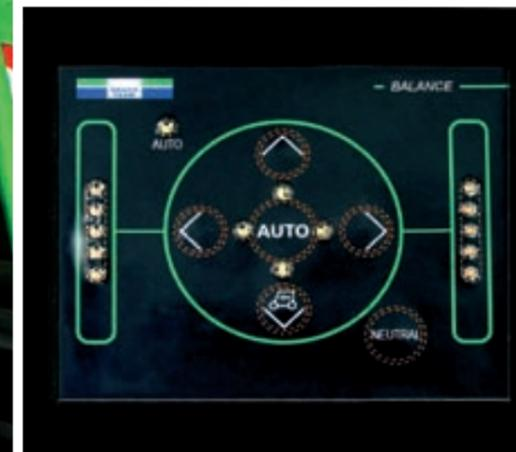
Die Leuchtdioden des Kontrollgeräts informieren den Fahrer jederzeit über die Neigung des Mähdeschers und erleichtern die Bedienung.
