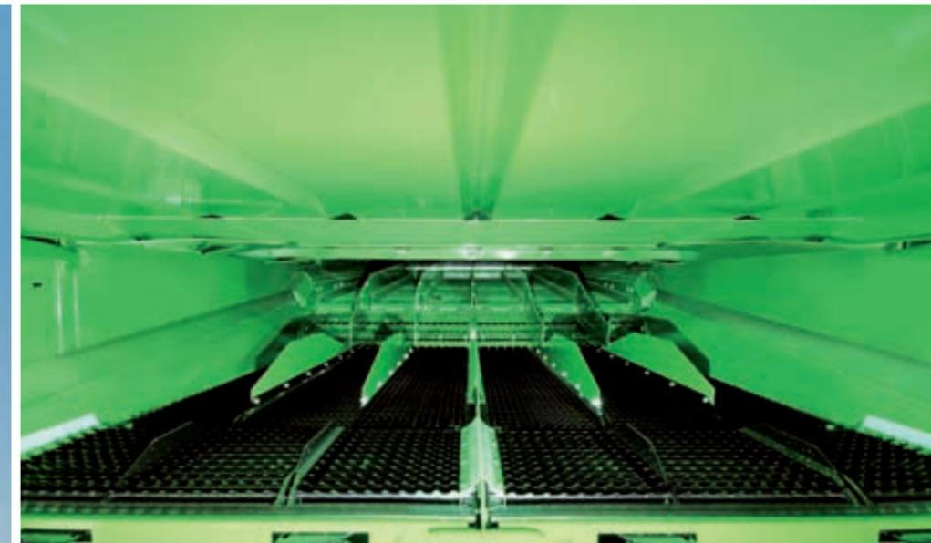
Die großflächigen Siebe garantieren herausragende Reinigungsleistungen. Die auf Wunsch lieferbare elektrische Siebverstellung erhöht die Leistungsfähigkeit des Mähdreschers zusätzlich.
