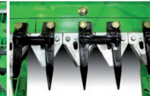
Die wechselseitig montierten Klingen reduzieren den Verschleiß und gewährleisten immer einen exakten Schnitt.
