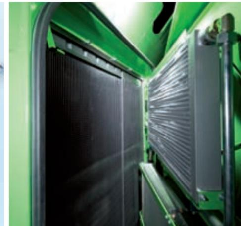
Für einen leichteren Zugang kann der Kühlergrill geöffnet werden.
