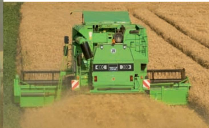
Gleichmäßige Verteilung des gehäckselten Strohs auch mit größeren Vorsätzen. Der Spreuverteiler sorgt für eine optimale Vermischung der Spreu.
