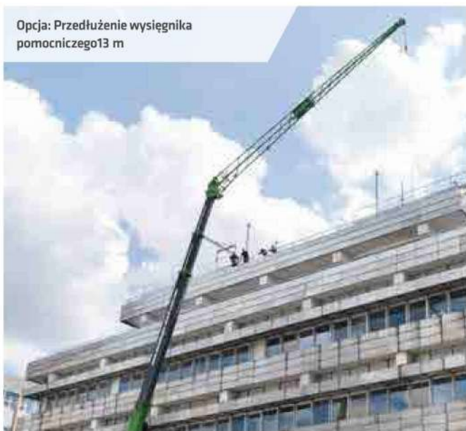
Wysięgnik pomocniczy z przedłużeniem, mocowany do wysięgnika głównego, gdy nie jest używany
