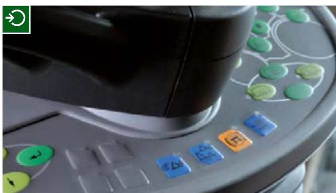
Tasti a membrana per blocco dell'attrezzo e attivazione dell'ammortizzazione.
