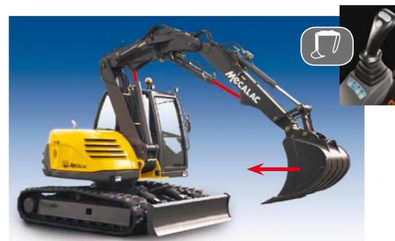
**COUPLAGE DE VÉRINS** : Maniement de l'équipement en 3 parties sans l'usage de pédales grâce au couplage de vérins (Brevet Mecalac).
