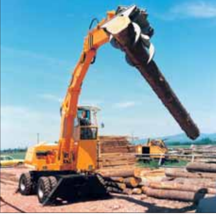
1974: Yükseltilmiş operatör kabinli kütük elleçleme makinesi
