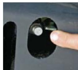
□ La pressione di pretensionamento del cingolo può essere facilmente regolata grazie ad un raccordo posto sul lato del carro.
