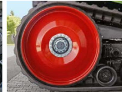
L'assale posteriore robusto è costruito per assicurare una durata di servizio particolarmente estesa. Il livello dell'olio di lubrificazione può essere verificato tramite finestra di ispezione.
