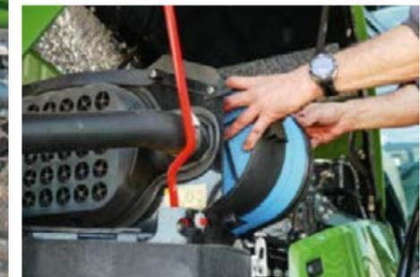
Vi è sufficiente spazio per la manutenzione grazie al coperchio monocomponente di grandi dimensioni. È possibile raggiungere confortevolmente il filtro aria dalla scaletta.
