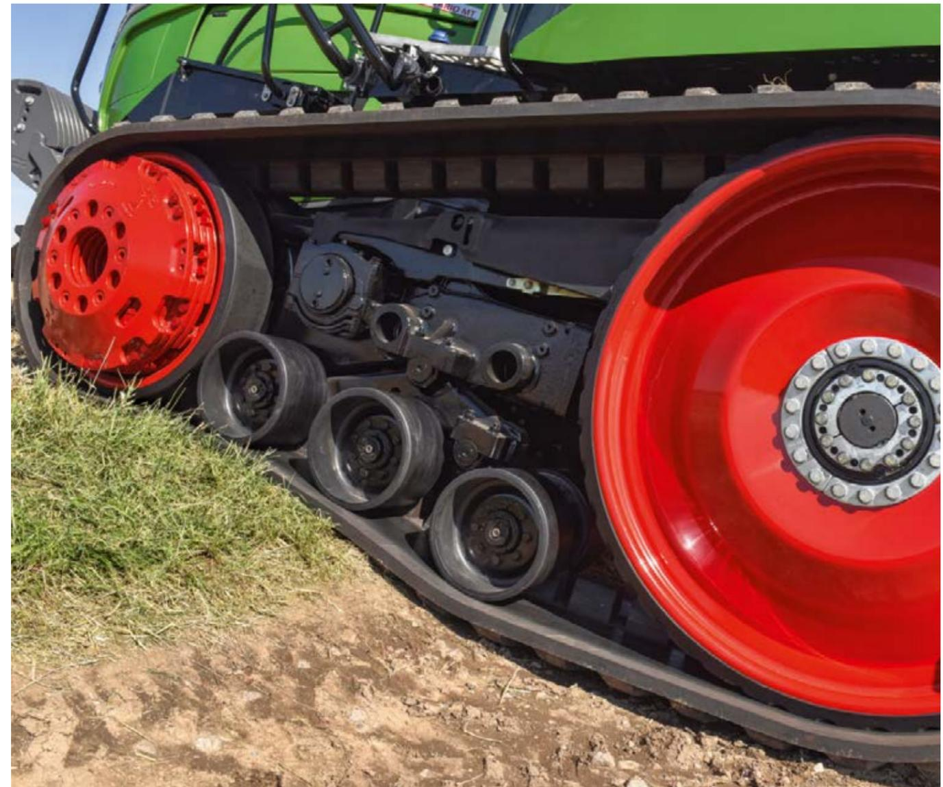
I rulli intermedi hanno un montaggio a molla e si adattano al profilo del terreno affinché non si perda il contatto con il medesimo e la potenza possa essere trasmessa in modo permanente.
