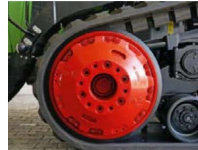
La trasmissione di potenza ottimale è assicurata dalle ruote motrici posteriori che azionano i cingoli tramite trazione.
