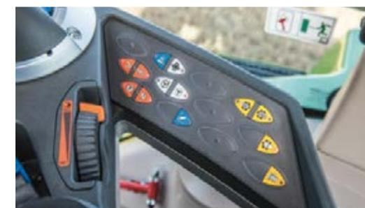
Regolare le impostazioni della trasmissione, dell'impianto idraulico e della presa di forza utilizzando i tasti a membrana del bracciolo.
