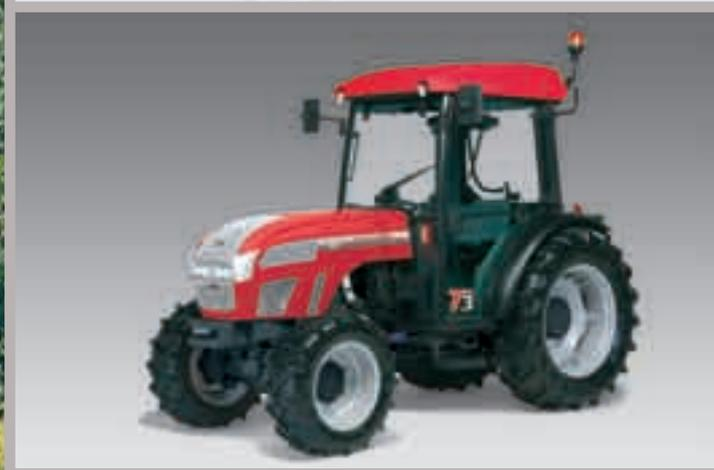
La gamma McCormick V (T3) per il vigneto ed F-N (T3) per il frutteto stretto, propone modelli caratterizzati dalle dimensioni estremamente compatte che si rinnovano con l'ottimizzazione dei comandi cambio, con il nuovo volante ad inclinazione maggiorata e il nuovo cofano dalla linea arrotondata con fari rettangolari integrati.
