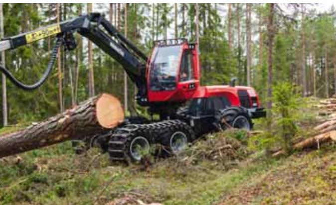
El exclusivo sistema hidráulico de 3 bombas le permite realizar simultáneamente varias operaciones, por ejemplo girar la grúa, alimentar el tronco y mover la máquina a la vez, sin perder fuerza hidráulica.
