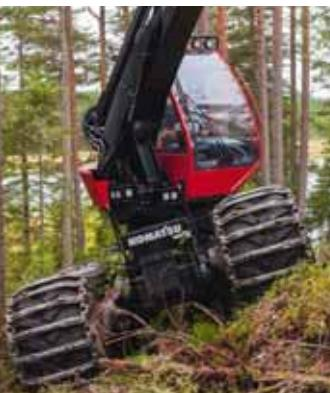
La nivelación de la cabina le permite estar sentado en posición horizontal, por eso no necesita tensar el cuerpo para mantener una buena postura de trabajo.
