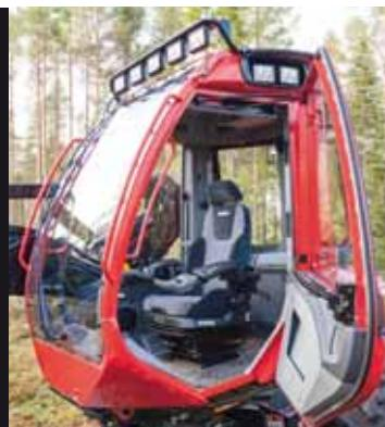
Nueva cabina de gran tamaño que minimiza el ruido, con amplias superficies acristaladas que confieren una visibilidad excelente hacia delante/abajo, delante/arriba y hacia atrás.
