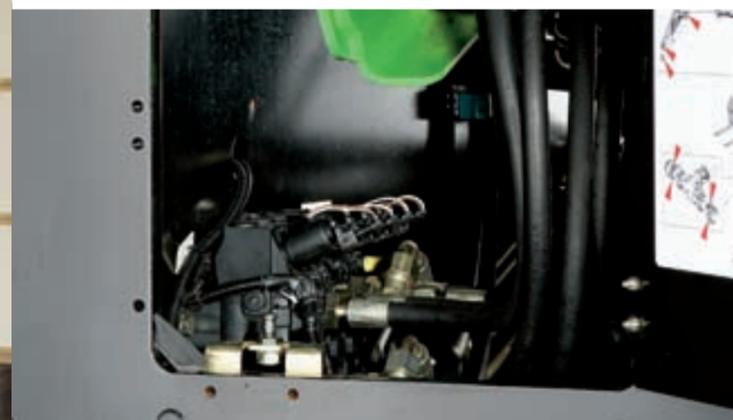
Die Steuerventile der Arbeitshydraulik sind generell LS-fähig und proportional steuerbar.
