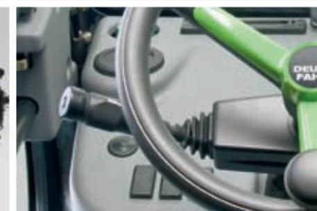
Die Fahrrichtung und die Fahrstufen werden bequem mit dem Powershuttle links unter dem Lenkrad gewechselt.
