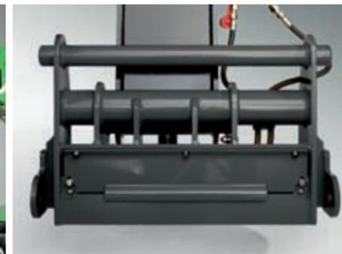
Schnellwechselrahmen mit hydraulischer Werkzeugverriegelung
