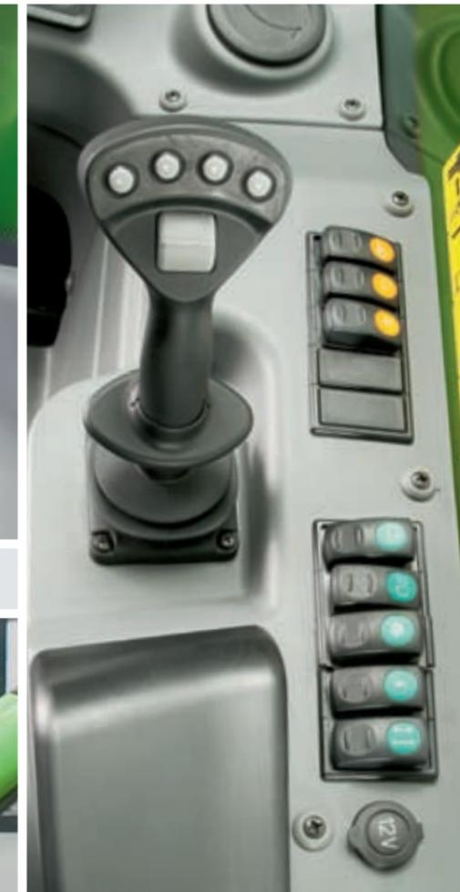
Mit dem Joystick werden alle Funktionen des Teleskoparms sicher und komfortabel gesteuert.
