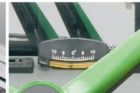
Die Neigung wird über die eingebaute Wasserwaage angezeigt.
