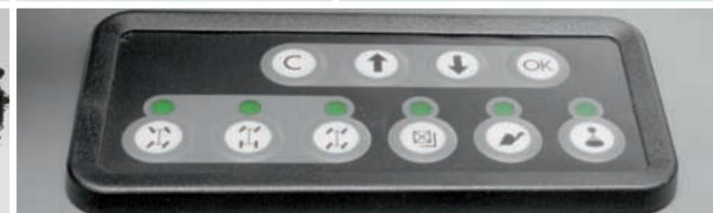
Die Wahl der jeweiligen Lenkart erfolgt einfach über die Folientaster in der Kabine. Die Umstellung der Räder in die Ausgangsposition geschieht automatisch.
