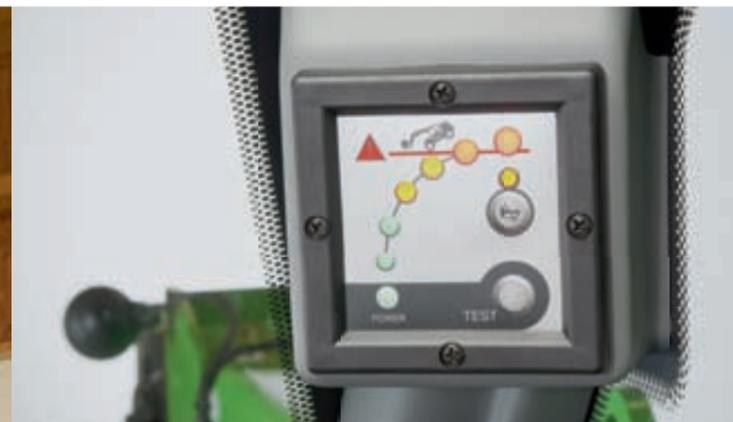
Der Fahrer kann schnell und sicher anhand der Buchstaben auf dem Innenteleskop und der Gradanzeige im Infocenter die Standsicherheit des Laders beurteilen.
