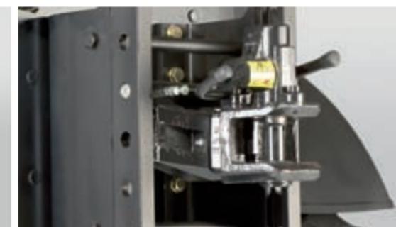
Automatische Anhängerkupplung mit Rasterschiene.
