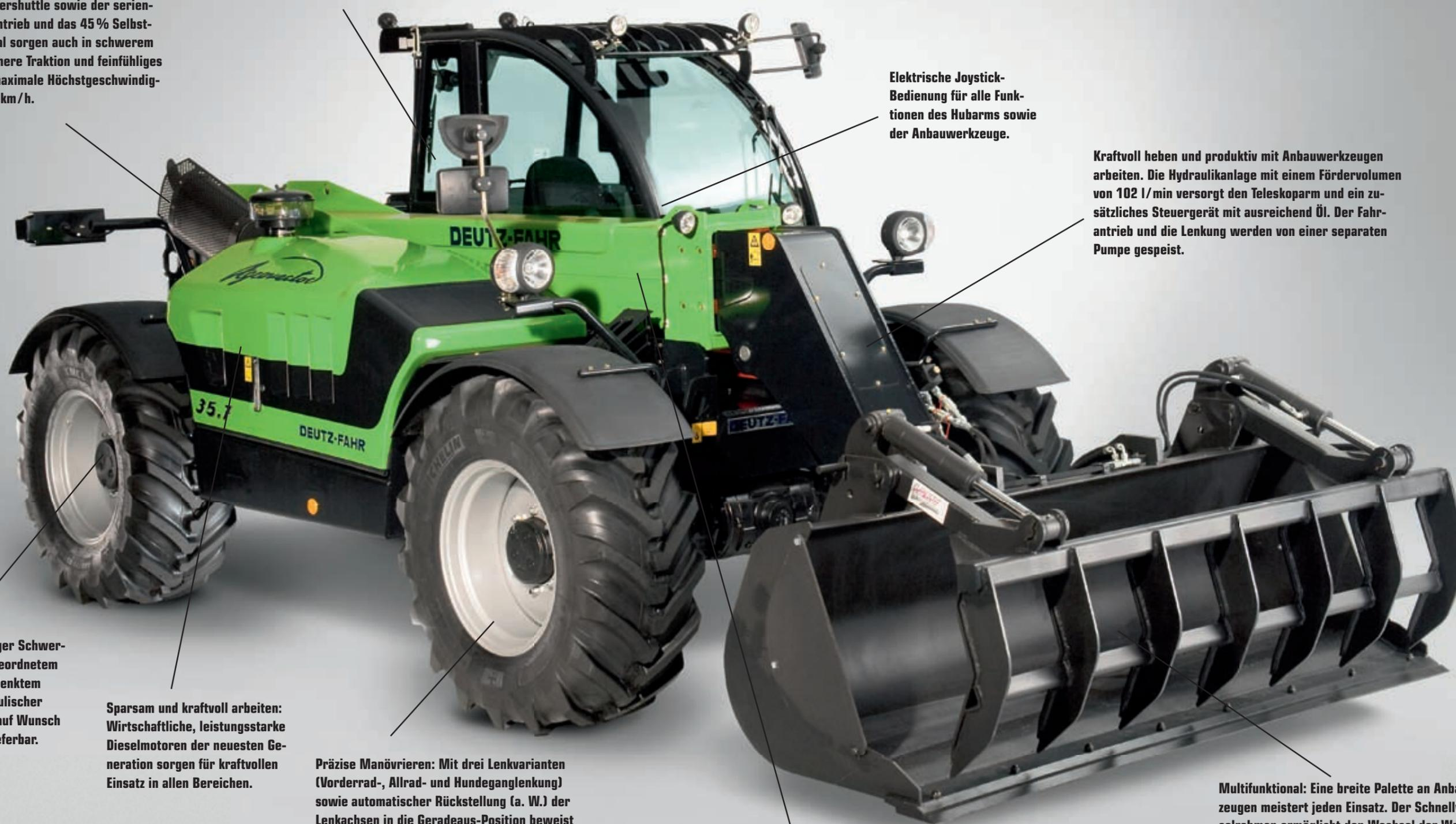
Sicherer Stand: Niedriger Schwerpunkt dank seitlich angeordnetem Motor und hinten angelenktem Teleskoparm. Ein hydraulischer Neigungsausgleich ist auf Wunsch bei dem Modell 40.8 lieferbar.
