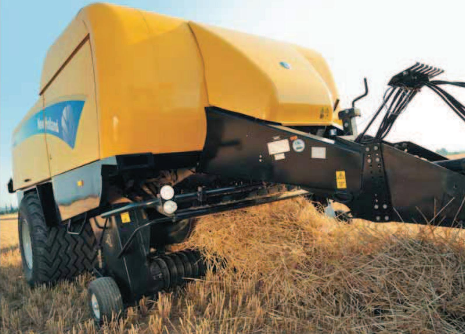
Jeder noch so kleine Halm Stroh oder Heu wird von der Super Sweep™-Pickup aufgenommen. Bewährte Merkmale wie abgewinkelte Zinken und enger Zinkenabstand sorgen in Kombination mit einem effizienten Niederhalter und luftbereiften Tasträdern für eine saubere Erntegutaufnahme mit hoher Geschwindigkeit.
