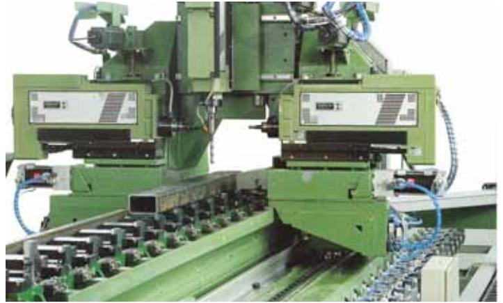
Toutes les poutres sont percées sur une unité de perçage spécialement développée à cet effet. Tous les perçages sont réalisés lors d'un seul passage, ce qui garantit une précision absolue sur le produit fini.
