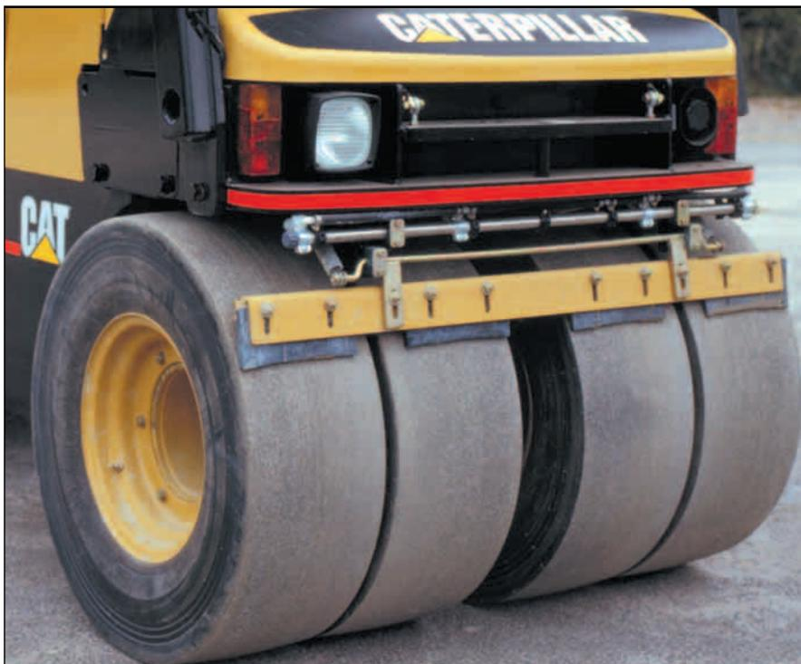
**Bandagen-/Reifenkombination.** Vorderbandage und Hinterreifen vereinen die Eigenschaften von Vibrations- und Gummiradwalzen in einer einzigen Maschine.
