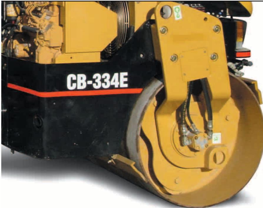
**Bandagenkanten.** Abgeschrägte Bandagenkanten verringern Oberflächenschäden bei großer Schichtdicke sowie Kurvenfahrten.
