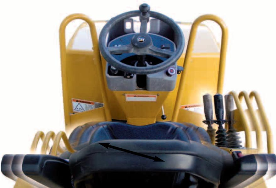
**Fahrersitz.** Der verschiebbare Fahrersitz mit drei Stellungen (rechts, mittig, links) sorgt für unbehinderte Sicht auf Bandagenecken bzw. Reifenkontaktflächen.
