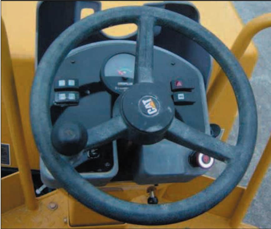
**Anzeigen.** In der Instrumentenkonsole an der Lenksäule sind Kraftstoffvorratsanzeige, Betriebsstundenzähler und Kontrollleuchten übersichtlich angeordnet.
