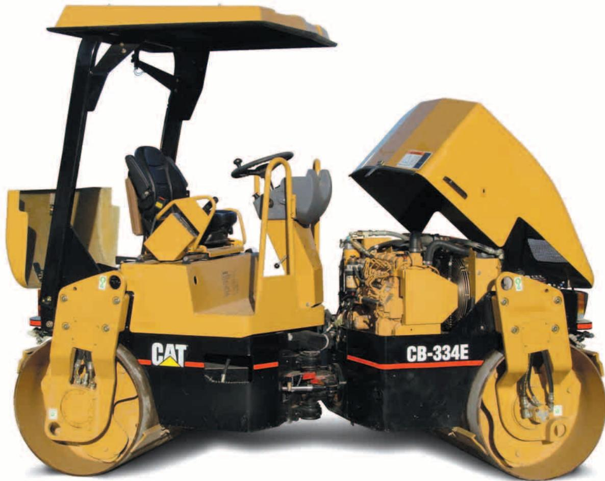
**Motorhaube.** Die hochschwenkbare, arretierbare Motorhaube aus glasfaserverstärktem Kunststoff ermöglicht einen unbehinderten Zugriff auf Dieselmotor und Nebenaggregate.
