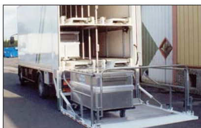
S732 Barriere di sicurezza sui 3 lati per il contenimento di carrelli
