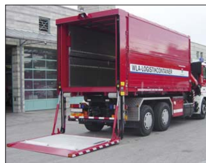
DH-VBC2 1000-2500 kg - Sviluppato per container & smontaggio di corpi
