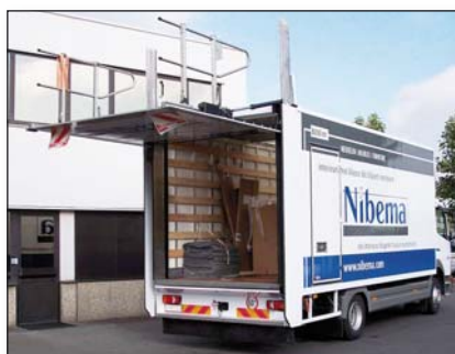
DH-VBA 750-1000 kg - Sponda completamente in alluminio con un peso proprio ridotto
