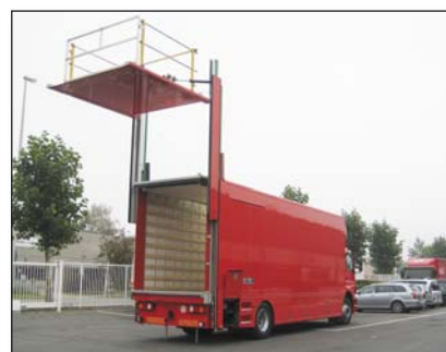
DH-VO5 1000-2000 kg - Altezza di sollevamento fino a 6 m sopra il livello del suolo
