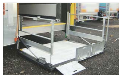
S751 Barriere di sicurezza montate sulle guide di scorrimento invece che sul pianale
