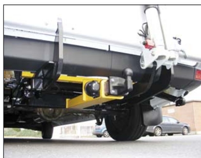
S371 Preparación para el acoplamiento de bola (desmontable) (sólo soporte del montaje)
