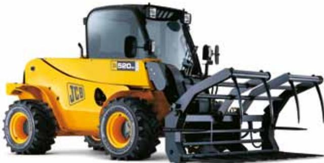
Las JCB 515-40 y 520-40 lleva el rendimiento de las Telescópicas JCB compactas a terrenos y edificios agrícolas inaccesibles hasta ahora. Con una capacidad de 1,5 y 2 toneladas respectivamente, hasta una altura máxima de 4 metros, la 520-40 es la solución perfecta para el trabajo en lugares con limitaciones de espacio. Estas capacidades, en máquinas de menos de 2 metros de altura y 1,6 metros de anchura, son una alternativa más versátil, cómoda y estable a las minicargadoras.
