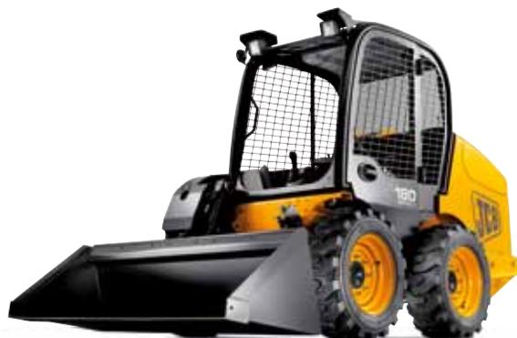
Tras amplios estudios de mercado que identificaron que el riesgo clave asociado al diseño típico de las minicargadoras era la seguridad del operador, la minicargadoras JCB fueron las primeras en ofrecer la seguridad y comodidad del acceso lateral por una puerta –único en el mercado.
