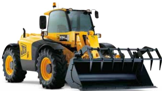
Diseño de vanguardia, calidades fuera de serie y una sorprendente lista de equipamientos se traducen en una excelente relación calidad-precio. Todo esto lo encontrará en los modelos "FS" 536-60, 531-70, 536-70, 541-70 y 535-95. Con un motor de montaje lateral y una pluma baja, estas máquinas ofrecen una excelente visibilidad desde todos los ángulos y gran estabilidad con carga elevada.
