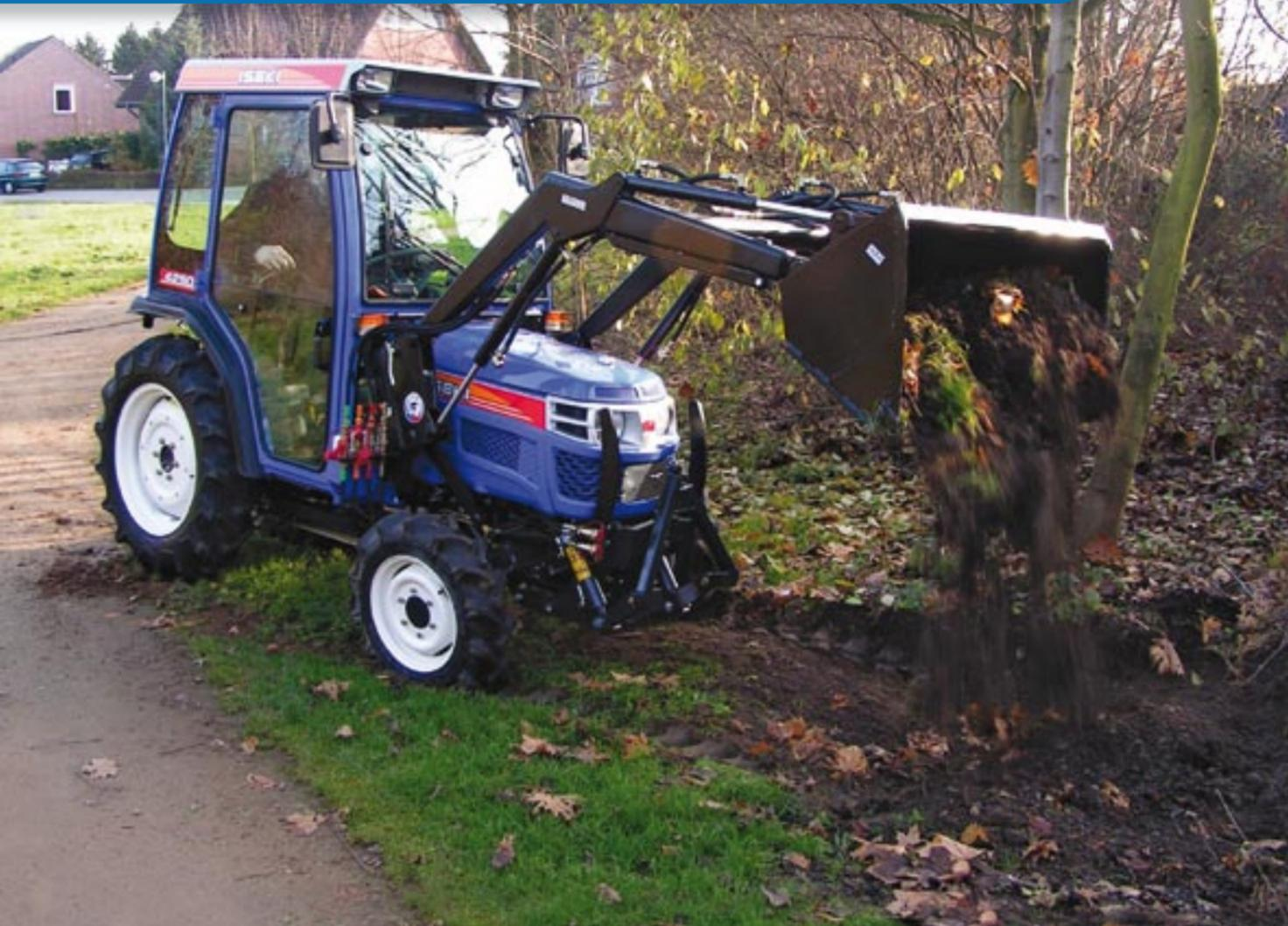
Bewährt haben sich die Frontlader der TH-4000-Serie. Unsere Ingenieure haben hierbei besonderen Wert auf eine große Hubkraft und einen leichten An- und Abbau gelegt. Innerhalb einer Minute ist der Abbau erledigt und es kann mit einem anderen Frontanbaugerät weitergearbeitet werden. Auf dem Bild ist deutlich zu sehen, dass bei einem ISEKI der TH-4000-Serie der Frontkraftheber für die Verwendung eines Frontladers nicht demontiert werden muss.
