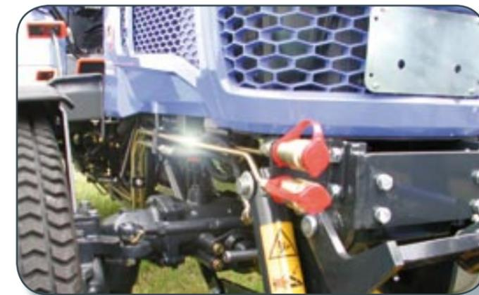
Bei ISEKI ist es selbstverständlicher Standard, dass leckagesicherte Norm-Stahlrohrhydraulikleitungen verwendet werden. Bei Profigeräten sollten diese generell bevorzugt eingebaut werden, um die Funktion dauerhaft zu gewährleisten.
