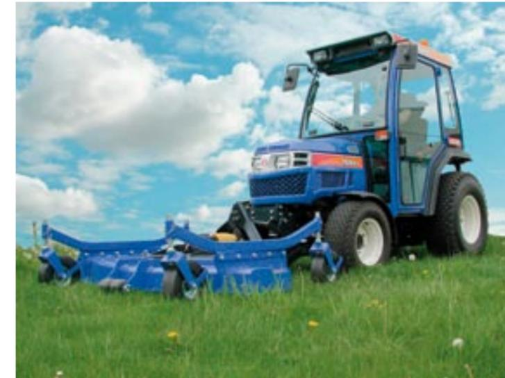
Frontmäherwerke bieten eine deutlich bessere Schnittqualität als Zwischenachsmäherwerke, weil zuerst vorn das Gras abgeschnitten wird. Dadurch wird eine Spurbildung von den Rädern vermindert, wenn anschließend der Traktor über die geschnittene Fläche fährt. Große Schwenkräder an der Grasaufnahme sind optimal für die Rasenschonung.
