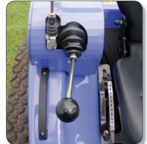
Die Standard-Hydrauliksteuerung befindet sich gut erreichbar neben dem Fahrer auf der rechten Seite. Bereits in dieser Ausführung können 3 unabhängige Funktionen gesteuert werden.
