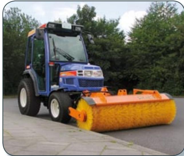
Frontkehrmaschinen bieten wir mit 130 cm oder 150 cm Arbeitsbreite an. Zudem stehen zwei Baugrößen für einfache oder professionelle Einsätze zur Wahl. Optional können ISEKI-Frontkehrmaschinen mit einem Schmutzbehälter oder Seitenbesen ausgestattet werden.
