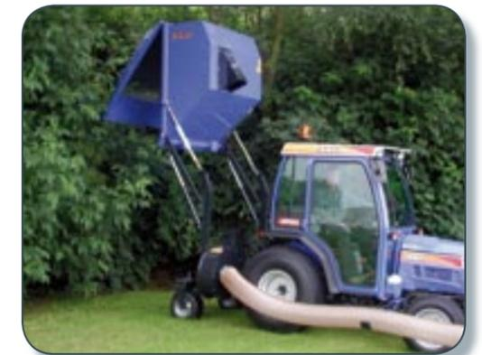
Bis zu 210 cm Aushubhöhe können erreicht werden, selbstverständlich bequem vom Fahrerstand aus gesteuert.
