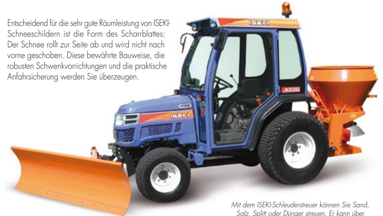
Mit dem ISEKI-Schleuderstreuer können Sie Sand, Salz, Splitt oder Dünger streuen. Er kann über eine Streubreitenverstellung von ca. 1 bis 5 m Arbeitsbreite eingestellt werden.
