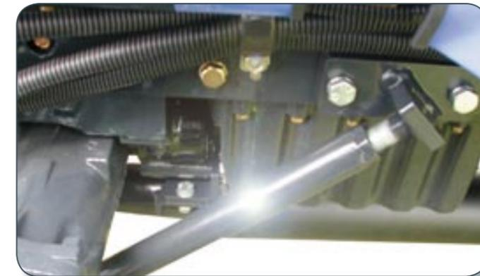
Schwere Frontanbaugeräte geraten bei Straßenfahrten oft in Schwingungen. Da ist es besonders wichtig, eine robuste Rahmenabstützung zu haben, um die Schwingenergie aufzunehmen. Bei den TH-4000ern ist diese Rahmenabstützung ab Werk an jedem Traktor montiert.
