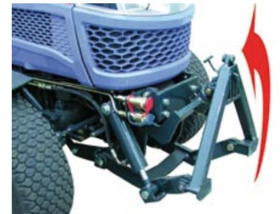
Beim Aushub wird durch eine bewährte Geometrie das Kuppeldreieck nach hinten abgewinkelt. So erreichen wir eine größere Aushubhöhe der Anbaugeräte und Hindernisse können bequem überfahren werden.
