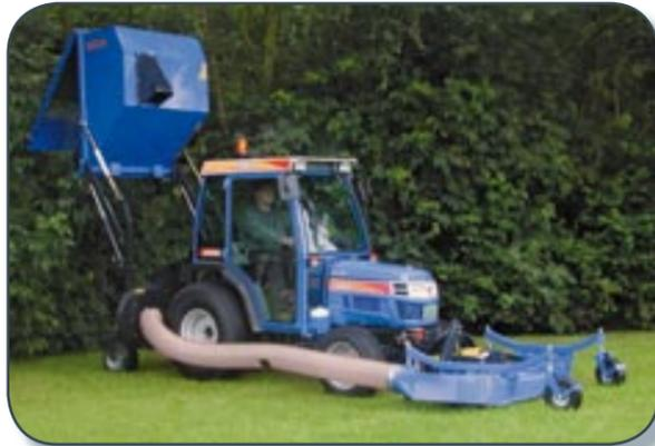
ISEKI-Grasaufnahmen bieten wir von 550 bis 1600 l Behältervolumen an. Selbstverständlich gibt es auf Wunsch eine Hochentleerung bis 210 cm Aushubhöhe. Beeindruckend ist die äußerst stabile Stahlbauweise mit der robusten Hochleistungsturbine aus Stahl.
