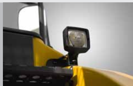
Phares de travail pour éclairer vers l'arrière, montés sur l'aile
