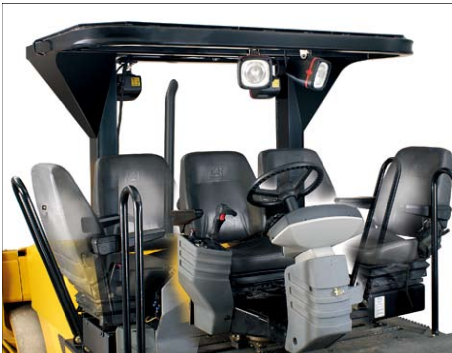
为了使 FOPS 能提供有效保护，操作员必须坐在顶棚下面
