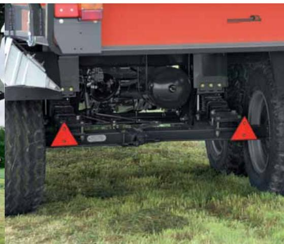
Die stabile gefederte Tandemachse sorgt für hohen Fahrkomfort (Feedex 360 T).
