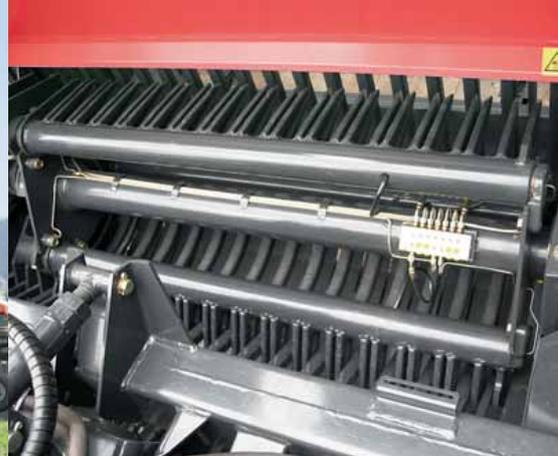
**Das leistungsfähige lenkgesteuerte Förderaggregat mit geschmiedeten Doppelfingerzinken.**
