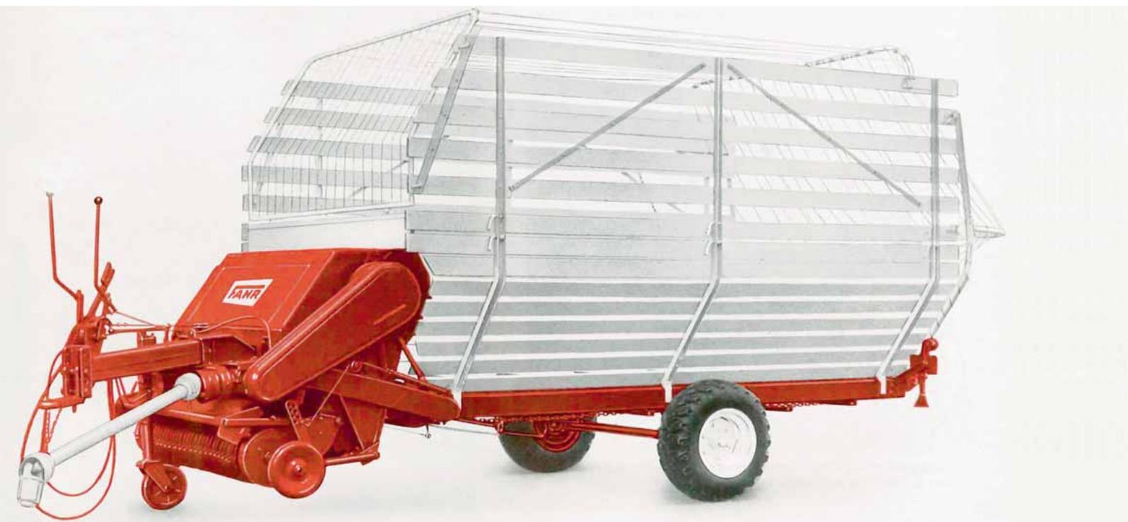
**1965 folgte das weltweit erste Modell mit kurzem Kettenförderer und Schneidwerk: FAHR WE 310 L.**
