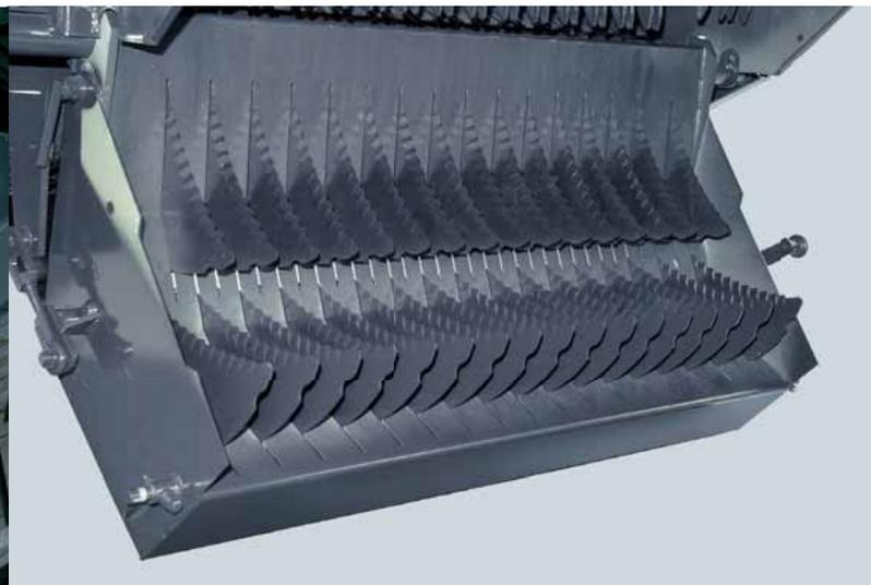
Das Schneidwerk besteht entweder aus einem Silierschneidwerk mit 16 Messern oder 17 Messern für den Förderkanal. Eine Kombination ist möglich.
