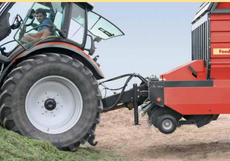
Die enorme Bodenfreiheit von bis zu 600 mm durch die hydraulische Knickdeichsel für die Modelle Alpex 220-Feedex 360T sorgt für sicheres Befahren von Rampen und Fahrhilfen.
