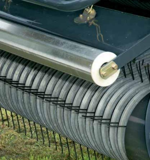
**Der Rollenniederhalter ist ab dem Feedex 300 integriert.**
