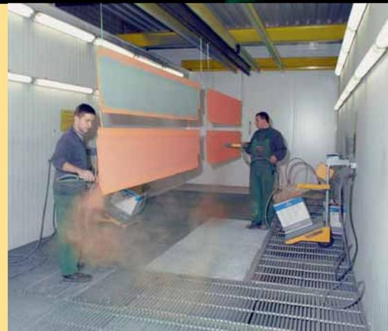
Die hochwertige Pulverlackierung schützt alle Bauteile nachhaltig vor Korrosion und Beschädigung.
