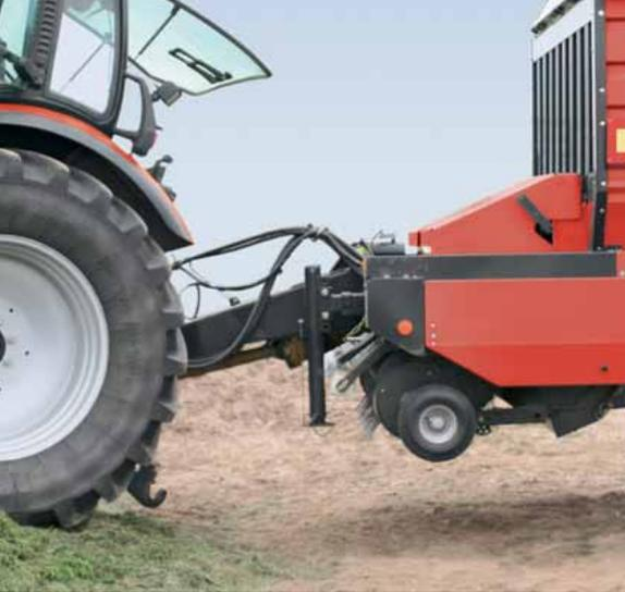
**Die hydraulische Knickdeichsel ermöglicht eine Bodenfreiheit von 600mm und somit eine sichere Anfahrt auf jedes Fahrilo.**
