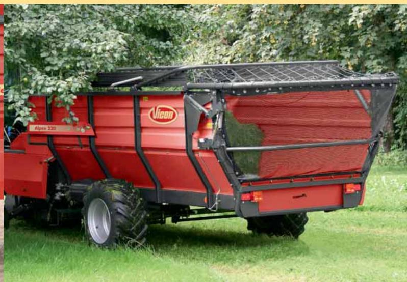
Der Hydraulisch verstellbarer Dürrgutaufbau für die Modelle Alpex 220-Feedex 360T ermöglicht ein bequemes Anpassen der Ladehöhe aus der Traktorkabine.
