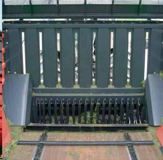
**Glatte Innenwände garantieren den sicheren Vorschub des Erntegutes.**
