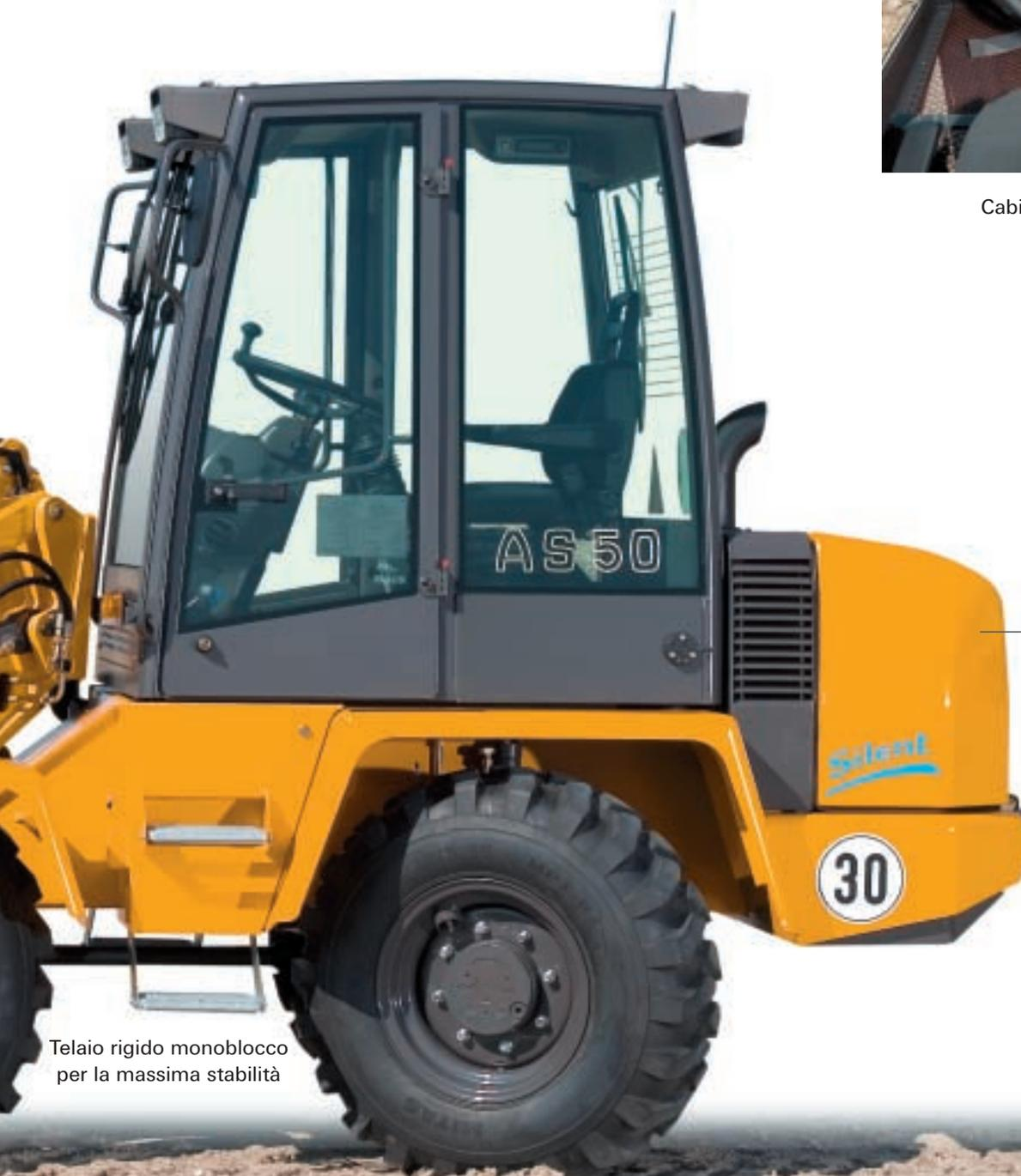
Telaio rigido monoblocco per la massima stabilità
