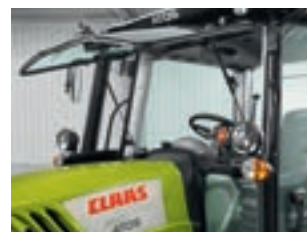
Para la ventilación natural de la cabina, el parabrisas delantero se abre ampliamente.
