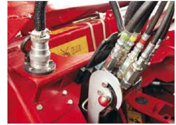
Monte el cabezal en cuestión de minutos utilizando el cierre único que conecta todos los servicios hidráulicos
