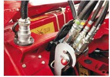
La testata può essere montata in pochi minuti grazie all'unico comando di sblocco che collega tutte le linee idrauliche
