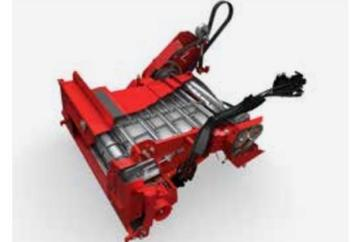
Gestione di testate fino a 9,15m di larghezza e protezione della mietitrebbia con il nuovo rullo a spirale e la vaschetta parasassi.
