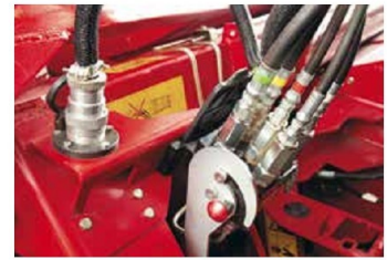
Montaż zespołu żniwnego w ciągu zaledwie kilku minut za pomocą jednego mechanizmu umożliwiającego podłączenie wszystkich złączy hydraulicznych
