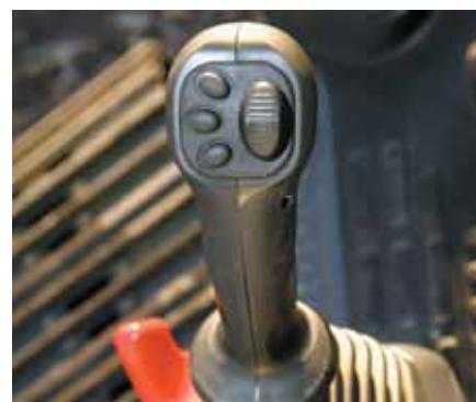
Léviers avec boutons de commande proportionnels pour les accessoires
