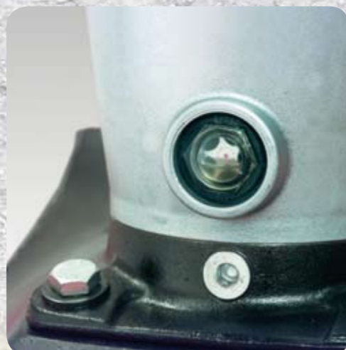
Sistema battente con controllo del livello olio
