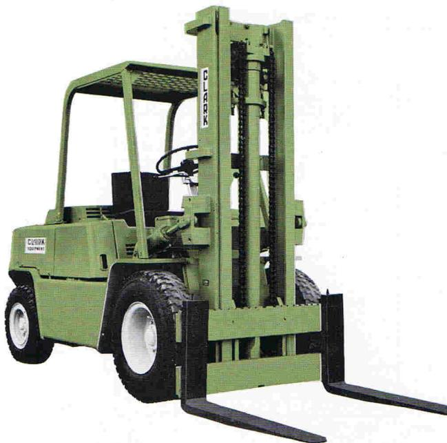
Im Hubzylinder befindet sich ein Senkbremsventil, das die Senkgeschwindigkeit in Abhängigkeit von dem Gewicht des Transportgutes selbsttätig reguliert.
