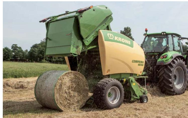
Förderrotor oder Schneidrotor mit 17 oder 26 Messern, Garn- oder Netzbindung, Einzel- oder Tandemachse und verschiedene Bedienterminals zur Auswahl.
