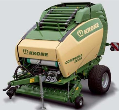
Einsatzfälle gerüstet. Die kleineren Ballen werden vielfach in Grassilage, die größeren in Heu und Stroh bevorzugt. Je nach Erntegut lässt sich die Pressdichte im Kernbereich des Ballens reduzieren, ideal zur Auslüftung von Heuballen.
