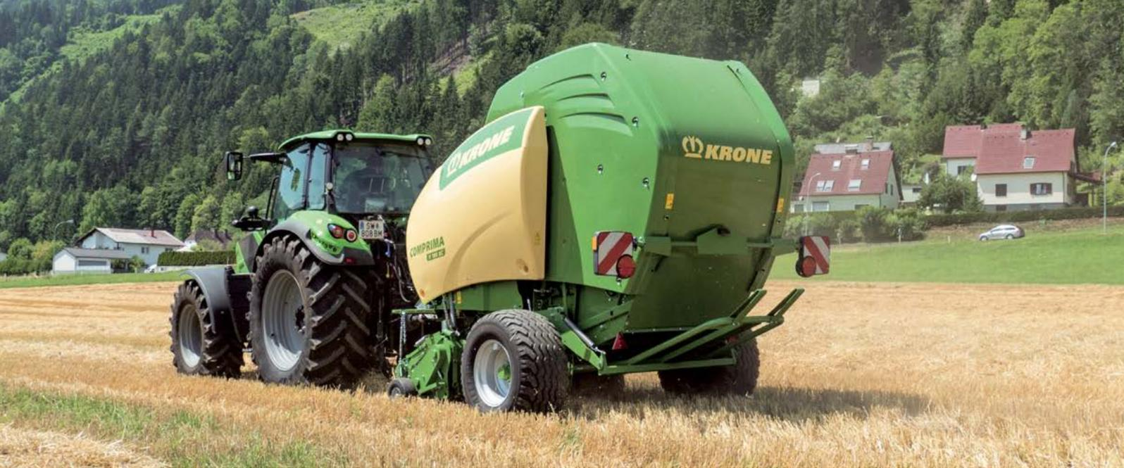
Comprima mit semivariabler Ballenkammer
