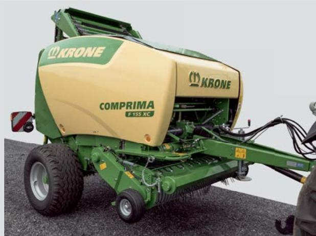
bile: è più economica, richiede meno manutenzione ed è particolarmente facile da utilizzare. È in grado di formare balle con diametri differenti, pressate dall'esterno verso l'interno; in caso di diametri ampi il cuore si presenta molto piccolo e morbido. Il risultato: balle con pesi elevati.
