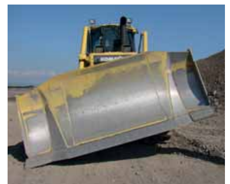
Hydraulisch verstellbarer Neigungswinkel: 870 mm
