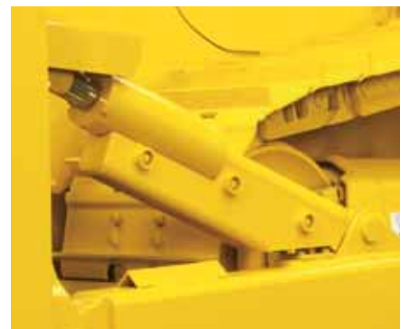
Die Hydraulikleitungen sind gut geschützt, wenn möglich innerhalb der Struktur, verlegt.
