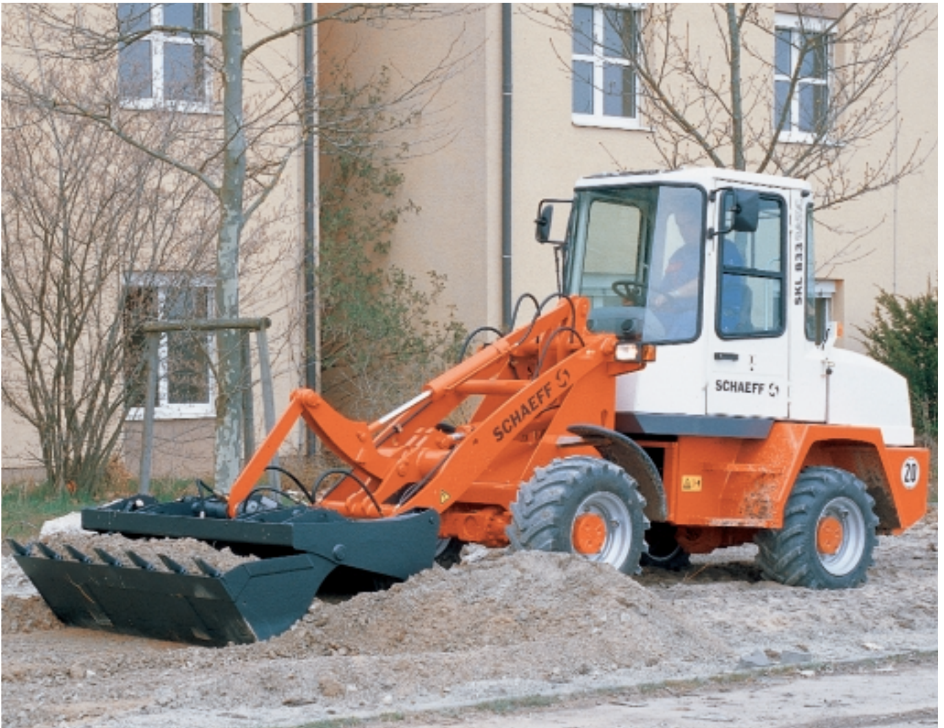
SKL 833 BASIC – Sonderausrüstung Unischaufel und Breitbereifung
