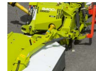
Protezione contro gli urti tramite dispositivo anticollisione non stop a comando idraulico: l'unità falciante si piega all'indietro e ritorna automaticamente alla posizione iniziale.
