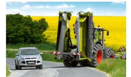
Meno di 4 metri: comoda posizione di trasporto con una buona distanza dal suolo sui due modelli BUSINESS.
