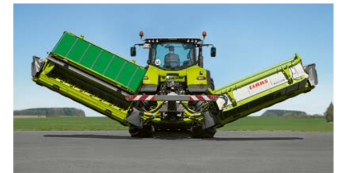
Il controllo professionale consente il sollevamento singolo e il ripiegamento individuale.
