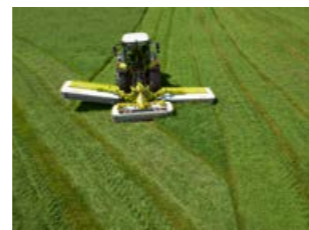
Sollevamento singolo delle unità falcianti a fondo campo.
