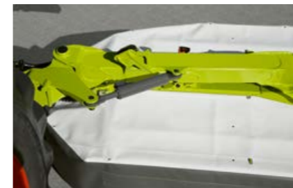
Protezione contro gli urti tramite dispositivo anticollisione non stop a comando idraulico - l'unità falciante si piega all'indietro e ritorna automaticamente alla posizione iniziale.
