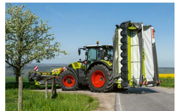
Con un'altezza di meno di 4 metri e molto compatta, come tutti i modelli DISCO: prima del ribaltamento le due unità falcianti vengono semplicemente rientrare con il sistema telescopico.
