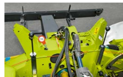
Un manometro per regolare con facilità la pressione d'appoggio di entrambe le unità falcianti.
