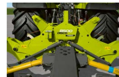
Testata d'aggancio stabile e compatta con sistema di scarico del peso al suolo ACTIVE FLOAT integrato di serie.
