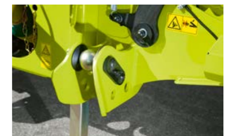
Linguette di guida bracci inferiori per un aggancio comodo.
