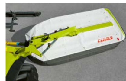
Disinserimento del dispositivo anticollisione meccanico: in caso d'urto la macchina si sposta all'indietro sollevandosi leggermente verso l'alto (dispositivo anticollisione idraulico non stop sulla DISCO 1100 TREND).
