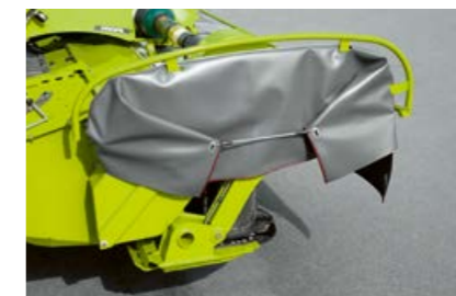
Grazie al punto di rotazione ribassato la DISCO PROFIL segue i contorni del suolo e non il trattore.
