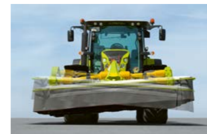
Adeguamento trasversale alla direzione di marcia grazie alla sospensione flottante.
