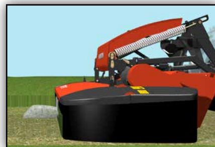
La suspension a été conçue pour protéger le lamier des corps étrangers.
