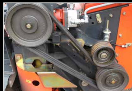
La vitesse du rotor réglable permet l'économie de carburant et la préservation de la récolte.
