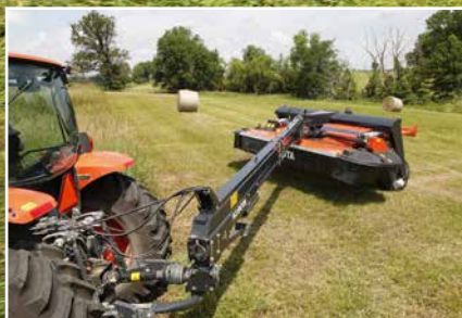
Une hauteur de levage de 20" (50 cm) assure une excellente garde au sol pour le transport et le tournage en bout de champ.
