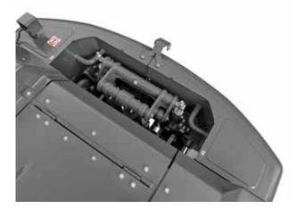
Sistema di abbattimento della polvere -Modalità Automatica/Manuale selezionabile
