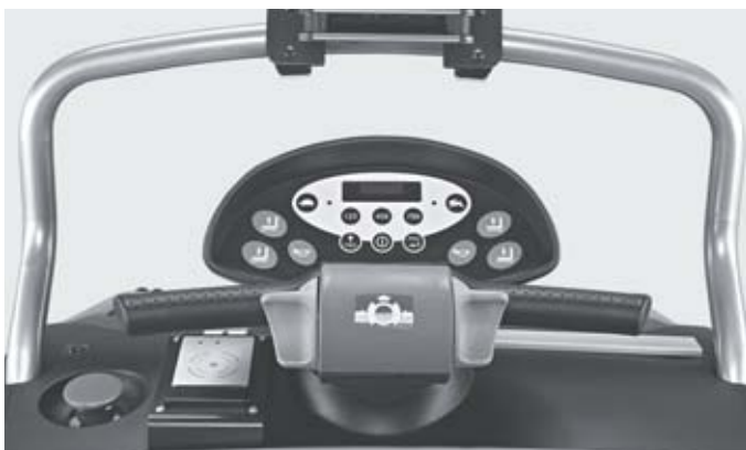
Wszystko w zasięgu ręki: dzięki STILL COCKPIT, zarówno prawo- jak i leworęczni użytkownicy mogą swobodnie sterować wszystkimi funkcjami 3
