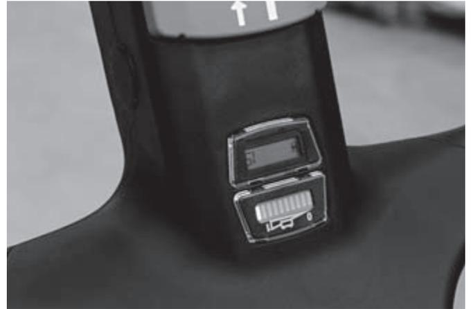
Leicht ablesbare Anzeigen für Batteriestand und Betriebsstundenzahl
