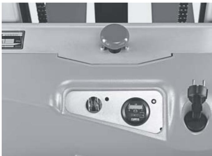
Toutes les informations nécessaires (charge batterie, horamètre) accessibles d'un coup d'œil sur l'afficheur LED
