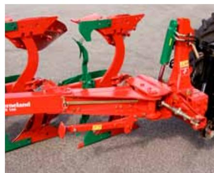
Les charrues Kverneland se distinguent de la plupart des autres charrues du marché par la position extérieure du vérin de remise en ligne. Grâce à ce système, la tige et le piston ne subissent aucune contrainte au travail.
