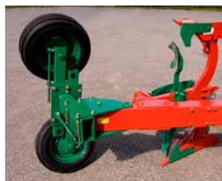
La charrue frontale ED est disponible avec une roue de contrôle travaillant dans la raie pour un bon contrôle de profondeur.
