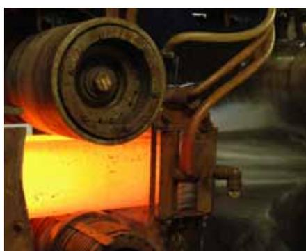
Inégalée, la technologie Kverneland des traitements thermiques des aciers Kverneland s'applique à toute la charrue. Elle assure légèreté et robustesse. Chaque élément bénéficie d'un traitement thermique spécialement adapté aux conditions les plus dures qu'il devra endurer.
