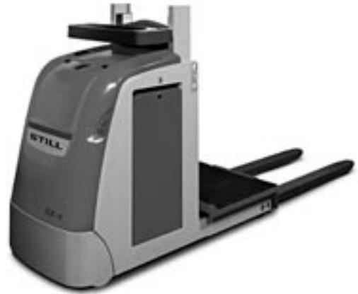
EK-X avec mât simplex – hauteur mât non déployé  $h_1$  : 1 500 mm
