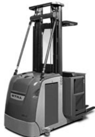
EK-X avec mât télescopique – hauteurs mât non déployé  $h_1$  : 2 400 - 2 900 mm
